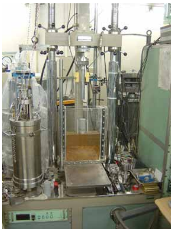
列車の振動荷重による地盤の変形実験 (動的載荷 100 万回)
