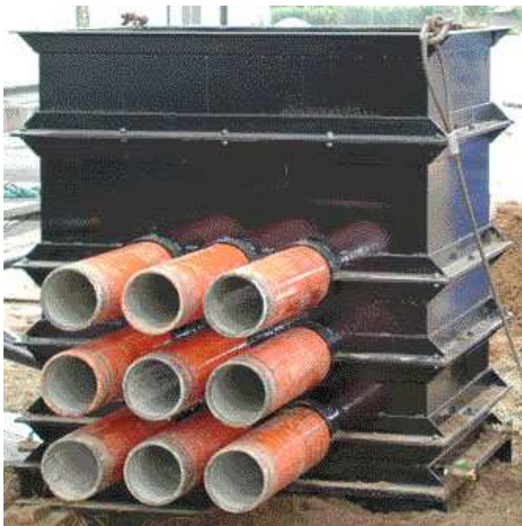
多条管埋設における改良土の締固め特性に関する実験
