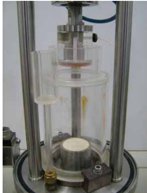
内部セル（底盤はセラミックフィルター）
