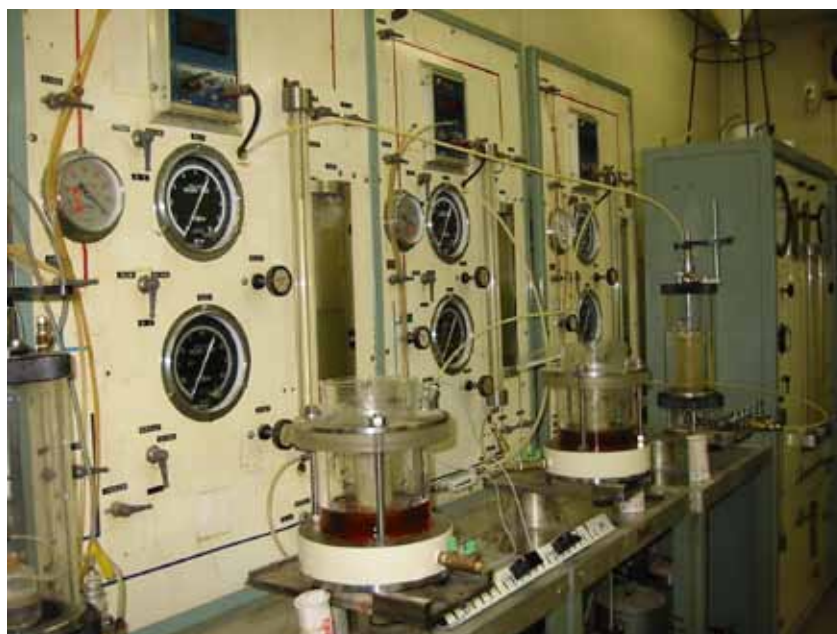
透気試験 (気体は、空気、炭酸ガス、窒素ガス等) (地盤中の透気係数を求める)
