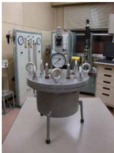
加圧板法装置
